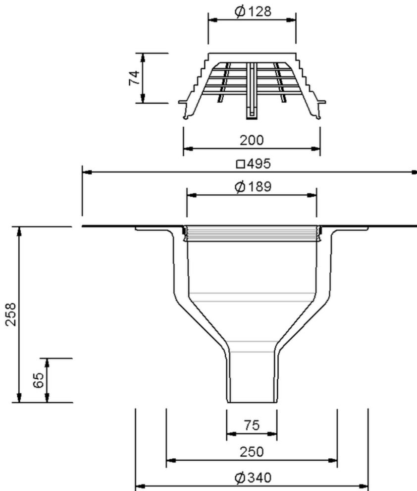
SitaStandard senkrecht DN 70, mit Bitumen-Manschette
