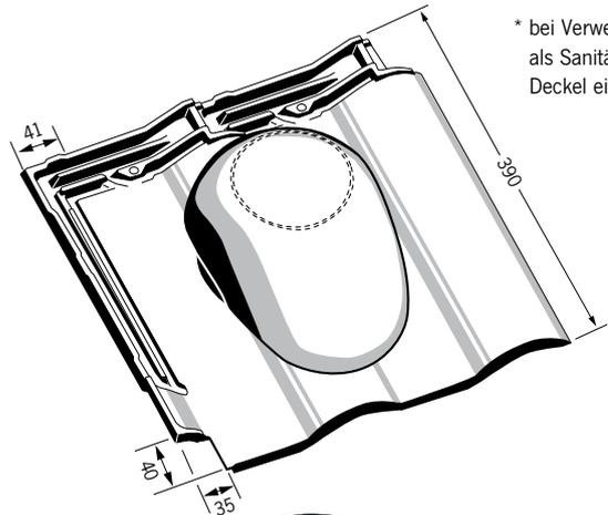
\* bei Verwendung als Sanitärziegel Deckel einfräsen
