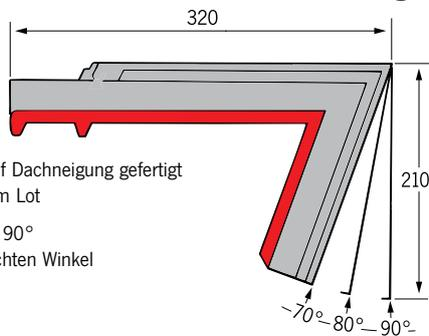
Pultdachziegel werden auf Dachneigung gefertigt
