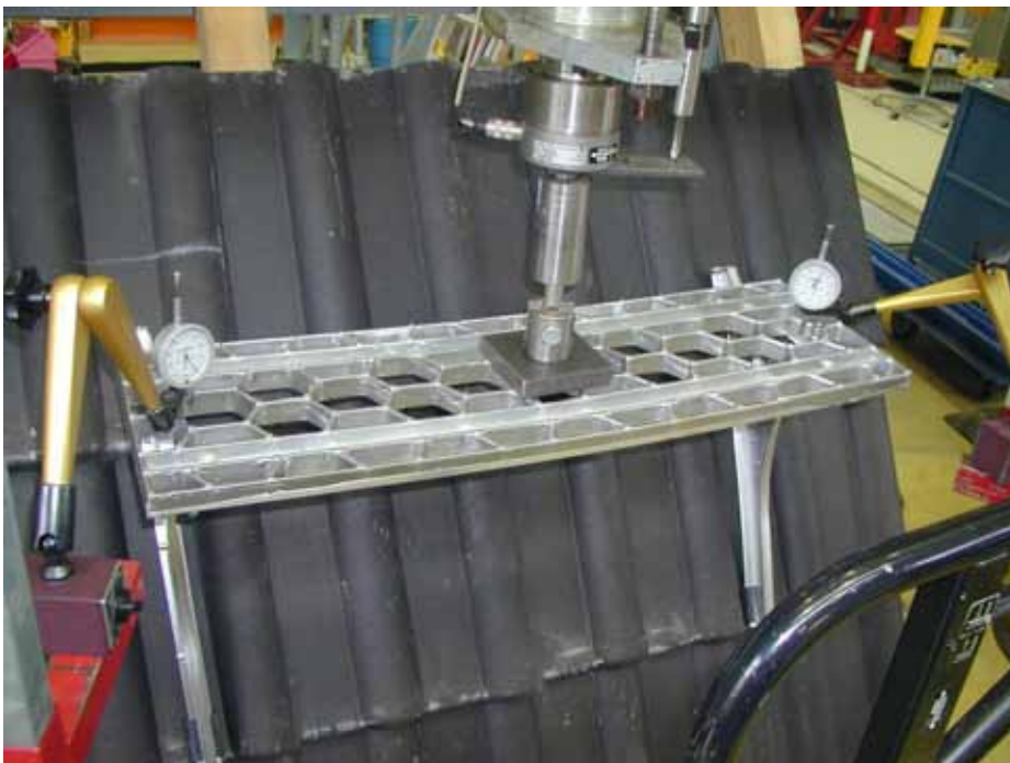
Bild 2: Prüfung des Standrostes in Stützweitenmitte
