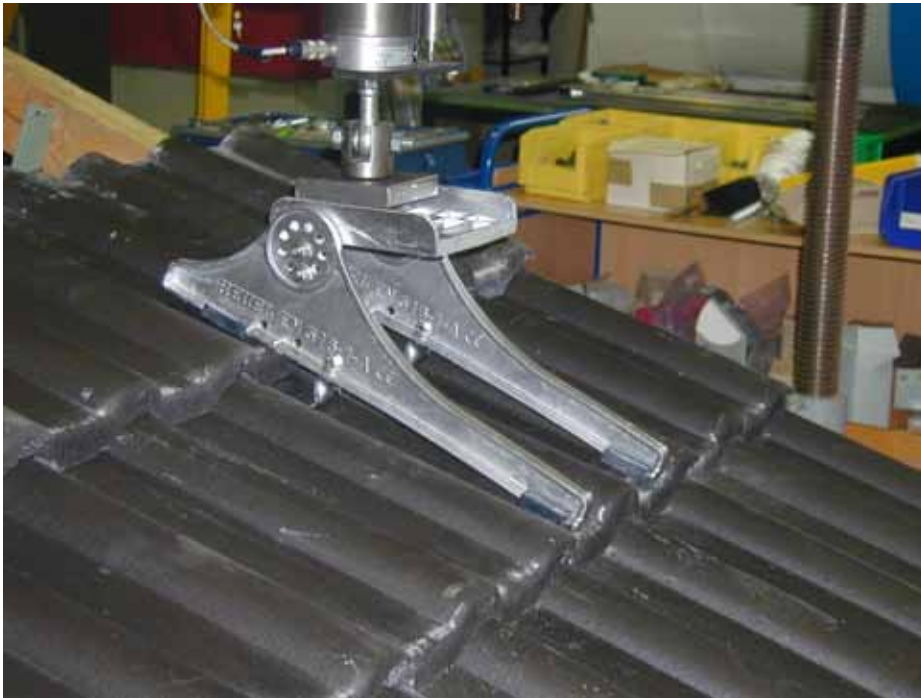
Bild 1: Prüfung des Steigtritts, Dachneigung 20°
