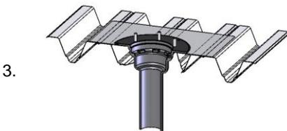
Die große Dichtmanschette über die Gewindestifte auf den Festflansch des SitaMulti auflegen. Bei einer bituminösen Dachbahn ist die Dichtmanschette nicht zu verwenden. Bei einer bituminösen Abdichtung wird die Bitumenbahn direkt auf den mit Bitumen-voranstrich behandelten Festflansch aufgeschweißt.
