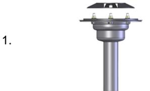
Den SitaDSS Multi Airstop über die Gewindestifte auf die Sechskantmutter des Druckströmungsgullys aufsetzen.
