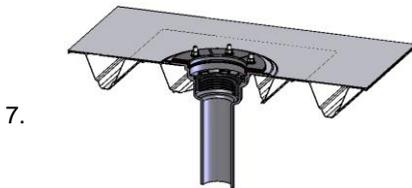
Den Winkeldichtring für die Rückstausicherheit innerhalb des Ablaufkörpers einsetzen, so dass die obere überstehende Lippe (zwischen den Nocken) auf den Kragenrand plan aufliegt. Den Winkeldichtring innerhalb, sowie das Aufstockelement im Rohraußenbereich, mit beiliegendem Gleitmittel einstreichen.
