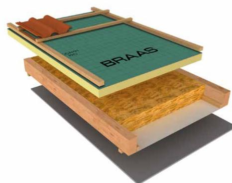
Kombination von Mineralwolle mit DivoDämm und DivoDämm Membran 2 2S.
