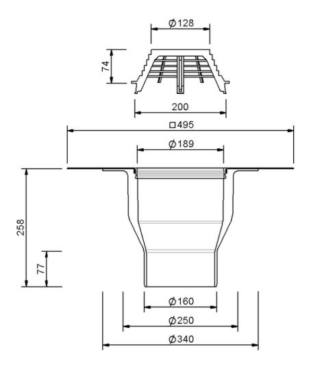
SitaStandard senkrecht DN 150, mit Bitumen-Manschette
